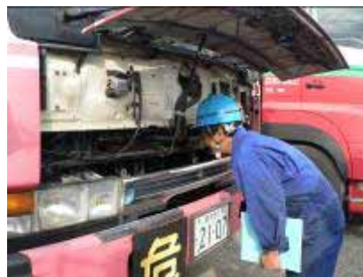
フロントパネルを開けて、オイル等の点検をします。
