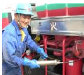
長谷川社員が、ニップルに付着している汚れを拭き取ってから、グリスを給脂します。
