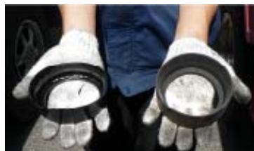
楕円形に変形したパッキン(左)と正常な形のパッキンです。
