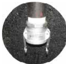
ワンタッチ金具(写真上)と、金具をはずしたところ
