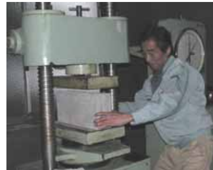
コンクリートブロックの強度を測定する装置
