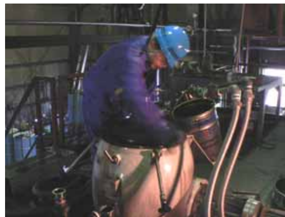
遠心分離機の清掃中
