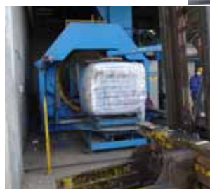
回転式梱包機。廃棄物が回転し、シートが巻かれて梱包されます。(左写真)
