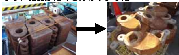
大型破碎機の刃。左側の写真は使用前で、使用後は右のように刃が摩耗します。
