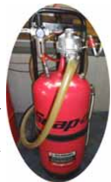
大型車を修理の際、ギアオイルを入れる装置を自分達で作りました。今までは手こぎで大変でしたが、エアーを使い自動で入れることができます。（右写真）
