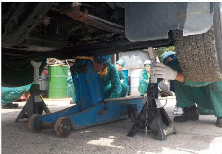
ジャッキアップは、平坦な場所で慎重に作業を行います。車輛前側はフロントアクスル部の中心部にジャッキを掛けジャッキアップします。フロントアクスル部にジャッキスタンドを掛けフロントを安定させます。車輛後側はリアアクスルのデフレンシャル部にジャッキを掛けジャッキアップし、ジャッキスタンドを掛けリアを安定させます。
