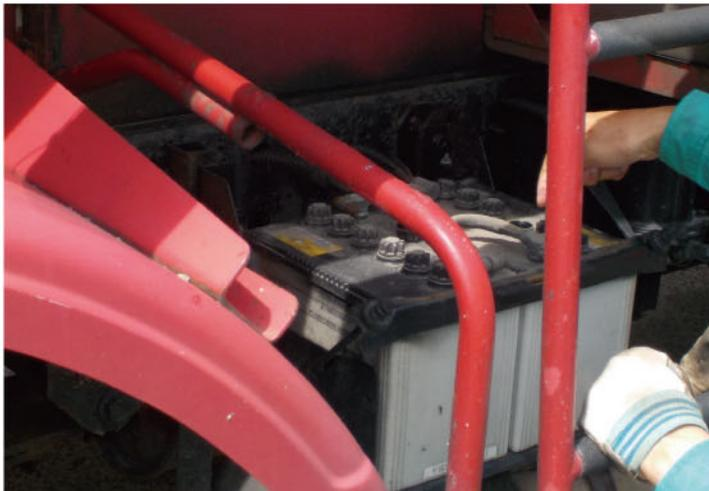
バッテリーは特に夏場にバッテリー上がりが起きやすいです。バッテリー液が基準のライン内に入っていれば良いですが、外からは見づらいなので、キャップを開けて、直接覗いてバッテリー液の量を確認します。少なければバッテリー補充液で補充します。
